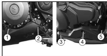
4. Para acceder al perno de drenaje del refrigerante, desatornille los 2 tornillos del lado izquierdo y los 3 tornillos del lado derecho.
