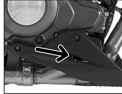
El número está impreso en el cárter del motor en la parte derecha del piloto e indica el número de serie de fabricación del motor. Anote este número en el espacio previsto.
