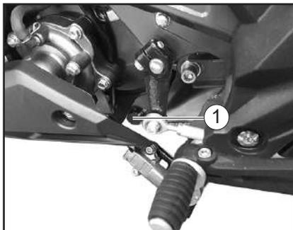
1. Perno de drenaje del aceite del motor
