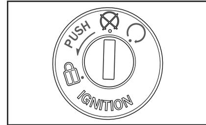
El interruptor principal/bloqueo de la dirección controla los sistemas de encendido y luces y se utiliza para bloquear la dirección.
