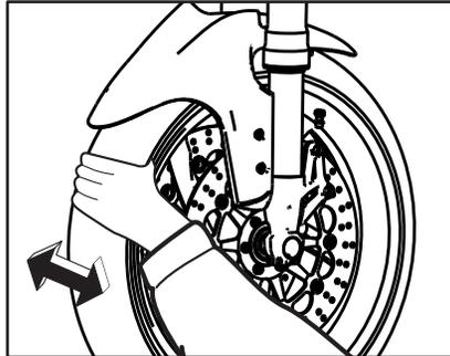
Debe comprobar los cojinetes de las ruedas delantera y trasera según los intervalos que se especifican en el cuadro de mantenimiento periódico y engrase. Si el cubo de la rueda se mueve o si no gira con suavidad, solicite a un concesionario Benelli que revise los cojinetes de la rueda.
