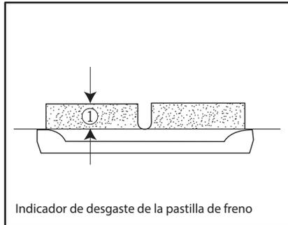
Cada pastilla de freno delantero dispone de indicadores de desgaste que le permiten comprobar el desgaste sin necesidad de desmontar el freno. Para comprobar el desgaste de la pastilla de freno, observe la posición de los indicadores de desgaste mientras aplica el freno. Si una pastilla de freno se ha desgastado hasta el punto en que un indicador de desgaste casi toca el disco de freno, solicite a un concesionario
