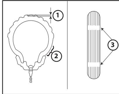
1. Profundidad del dibujo del neumático
