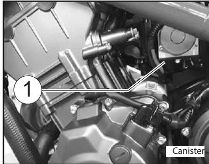
Este modelo está equipado con una bomba para evitar la descarga de vapores de gasolina a la atmósfera. Antes de utilizar este vehículo, efectúe las comprobaciones siguientes:
