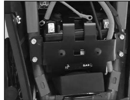
Este modelo está equipado con una batería VRLA (plomo-ácido regulada por válvulas).
