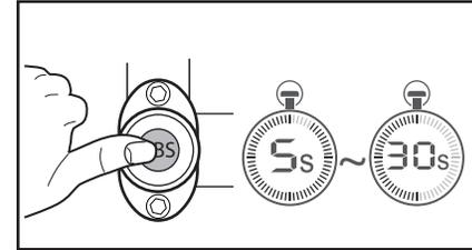
B: El sistema ABS volverá a activarse desde cualquier otra configuración anterior si se mantiene pulsado el botón por un tiempo superior a 30 seg.
