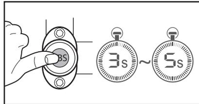
A: el sistema ignorará este procedimiento si se mantiene pulsado el botón ABS durante un tiempo comprendido entre 5-30 segundos. El sistema de ABS mantendrá las configuraciones corrientes.
