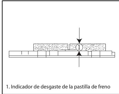
Cada pastilla de freno trasero dispone de ranuras indicadoras de desgaste que le permiten comprobar el desgaste de la pastilla sin necesidad de desmontar el freno. Para comprobar el desgaste de la pastilla de freno, observe las ranuras indicadoras de desgaste. Si una pastilla de freno se ha desgastado hasta el punto en que la ranura indicadora de desgaste casi aparece, solicite a un concesionario Benelli que cambie el conjunto de las pastillas de freno.
